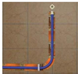
Obs.: Os tubos Multicamada não necessitam de tubos bainha nas instalações.
