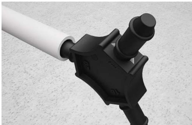
Passo 4: O chanfro feito pelo calibrador/chanfrador facilitará a entrada do tubo na conexão.
