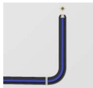
A inserção do tubo PEX no interior do tubo bainha deve ser feita com a parede ainda aberta.
