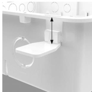
5) Termine a fixação parafusando a placa e os fixadores para DryWall. Utilize os rasgos existentes na borda do Quadro VDI como orientação de posicionamento dos fixadores. Caso preferir, parafuse os fixadores para DryWall direto no montante.
